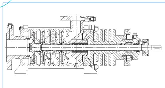
当安装一或两个离心式叶轮并串联一个或更多的侧通道层，两种传输原理的特定优点可彼此互补。
