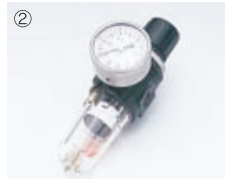
▲ 过滤减压阀 能去除压缩空气中的杂质、水分，并将压力降至工作压力。
