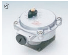
▲ 限位开关盒 自动检测阀门的开关位置，在控制面板上点亮指示灯，并通过继电器执行其他操作。
