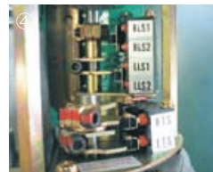
▲ 限位开关 区别于普通的限位开关，在不受马达电压的影响下也能获取开闭信号，并作其他操作。
