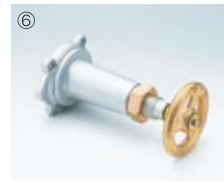
▲ 手动操作件 配备在气开，气闭型执行器上，当空压机停止供气的时候用来手动开闭阀门。
