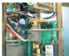
▲ 电位计 将阀门开度转换为电阻值，反馈给电-电定位器等组件。
