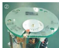
▲ 电-电定位器 接收到来自电位计的信号后，通常用作调整温度、流量及Ph值的控制阀来使用。
