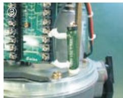
▲ 除湿器 用于去除执行器内的湿气，防止出现结露现象。
