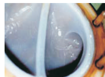
EL-PVDF/无发泡 (纯碱电解工厂/回流盐水) (88°C、0.3MPa、使用5年)
