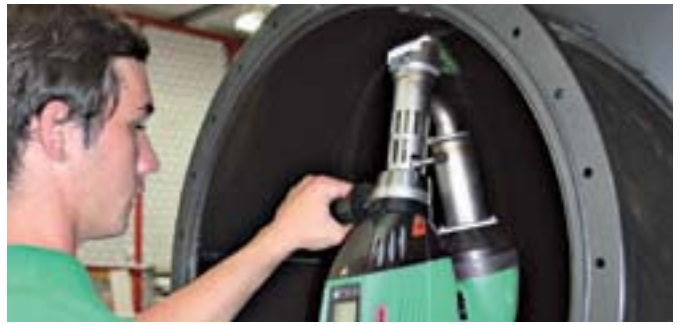
管道内部的弧形焊接也可以轻松进行。
