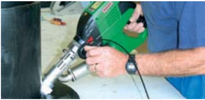
操作方便的 WELDPLAST S2 进行焊接。
