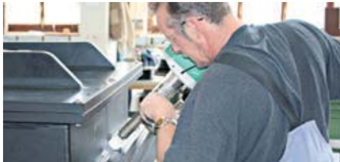
使用功能强劲的 WELDPLAST S4 进行焊接。
