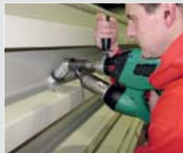
使用WELDPLAST S2配合弯角接头对塑料制品的细部进行焊接。(附件)
